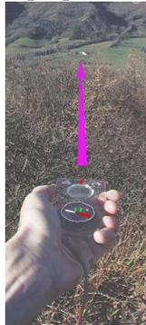
La boussole se tient bien à plat pour que l'aiguille soit libre dans sa rotation. Dès que la boussole est inclinée, une pointe de l'aiguille se pose sur le fond de la boîte et la bloque.
